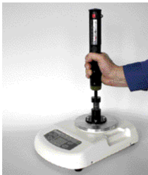
写真；電動トルクドライバの測定
