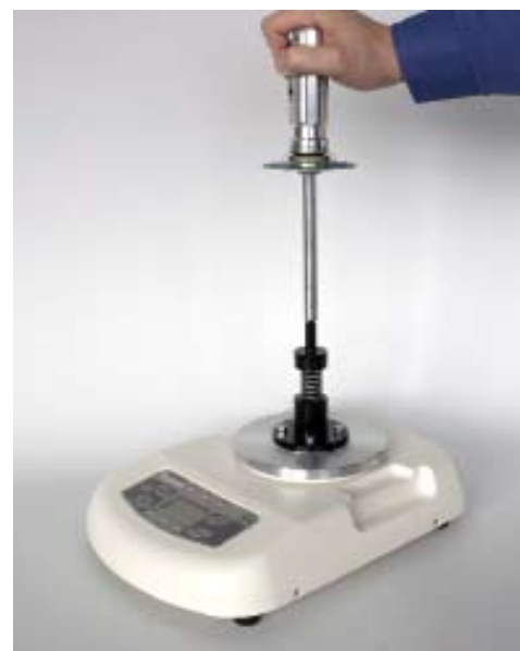
写真；トルクドライバの測定
